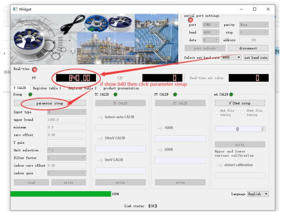
8. Нажмите, чтобы прочитать, в этих окнах будут отображаться параметры внутри преобразователя.
